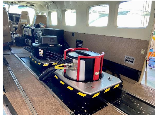
固定翼に搭載したALB機材
