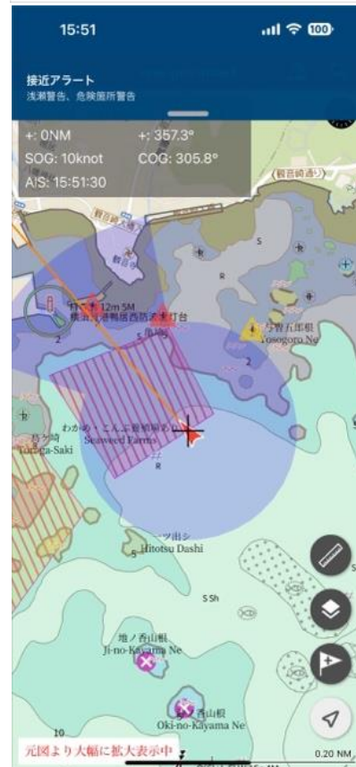
図8 近接アラートの設定と危険箇所近接時のアラート
