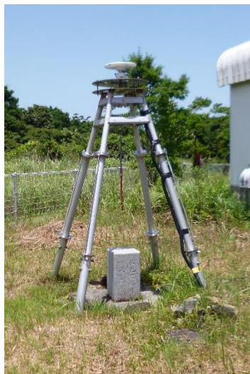
下里水路観測所構内の本土基準点
