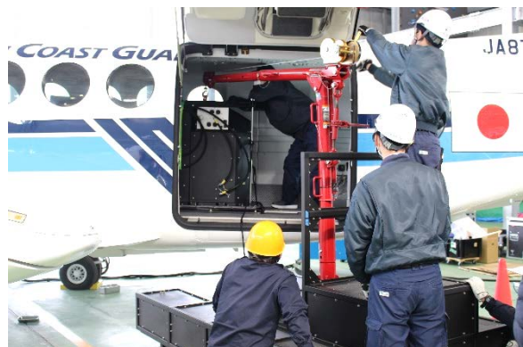
写真7 貨物扉より専用治具を用いた測深機搭載作業
