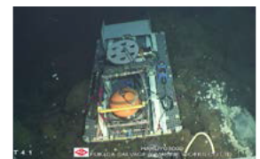
海底重力測定状況
