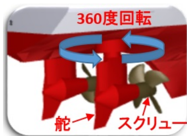
図1 アジマス電動推進器 概略図 ※舵とスクリューが一体となっており、360度任意の方向に推進力を向けることが可能
