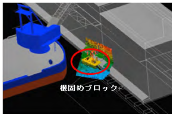
図8 根固めブロック据付状況
