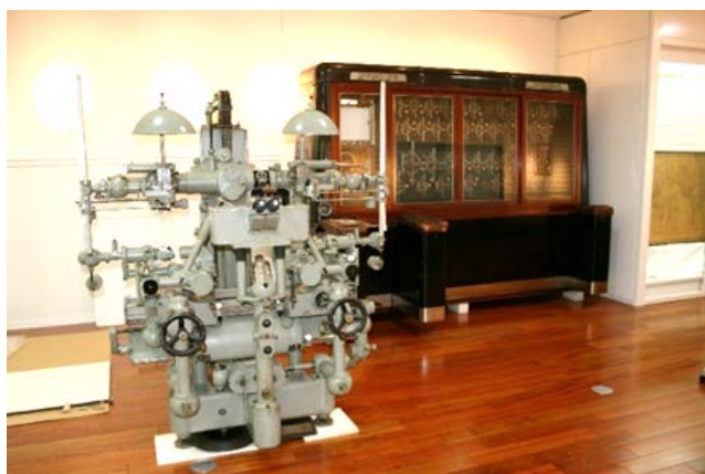
航空写真から海の波浪の高さを図化するための一級図化機（手前）と潮候推算機（奥）
