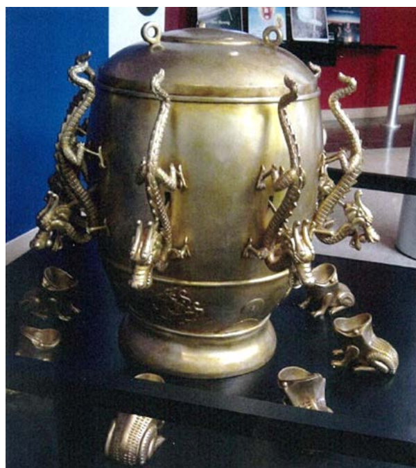
図4 張衡が発明した感震器 - 数種類のもので造られた - ( http://ja.wikipedia.org/wiki/ による)
