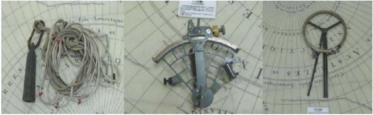
写真7 水深測量三点セット
