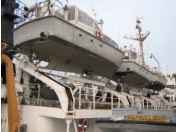
写真3「RAINIER」に搭載されているマルチビーム測 深機装備の測量艇
