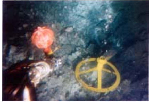
写真7 海底噴気孔に於ける採ガス状況(風船法)
