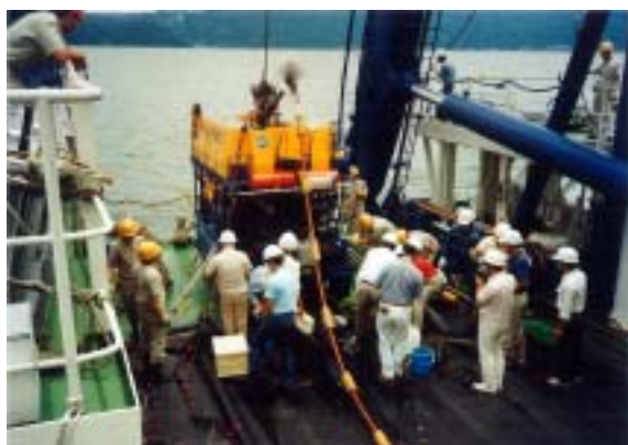
写真8 海洋科学技術センターの無人潜水探査機「ドルフィン3K」と母船「なつしま」
