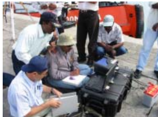
写真 5 基準点での DGPS 受信機のチェック
