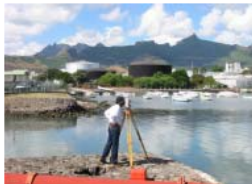
写真 6 トータルステーションによる岸線測量
