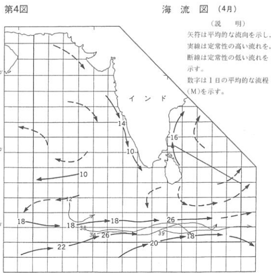
図4 偏流データ等による海流推定値(太線)と表層漂流プイの軌跡(細線)。数値は1日あたりの流程。(インド洋西岸水路誌, 1998から)
