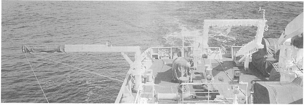
「拓洋」の後部。左から、イール、プロトン、エアガン、マルチチャンネル・ストリーマーケーブル。
