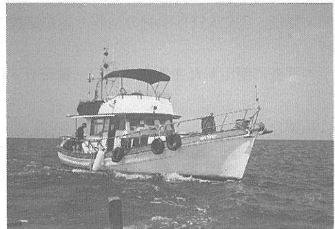
写真2 測量艇 Zeta II L : 14.3m, B : 3.9m, D : 0.8m, Main Engine : 378HP, Generator : 6 KVA, Cruising Speed : 12knots, Crew : 3 per- sons
