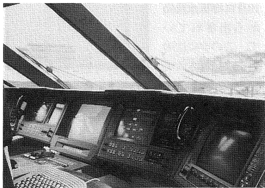
写真3 NECSのコクピット、右からレーダー（船外に備え付けられたテレビカメラの映像も切り替えられる）、機関関係の計器画面、電子海図画面。船長と航海士1人が操船し、このようなディスプレイが船長・航海士用に二つ用意されている。
